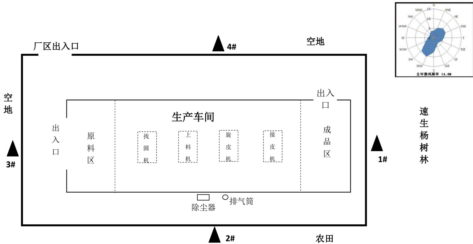
图 9.2-2 项目厂界噪声监测点位示意图
