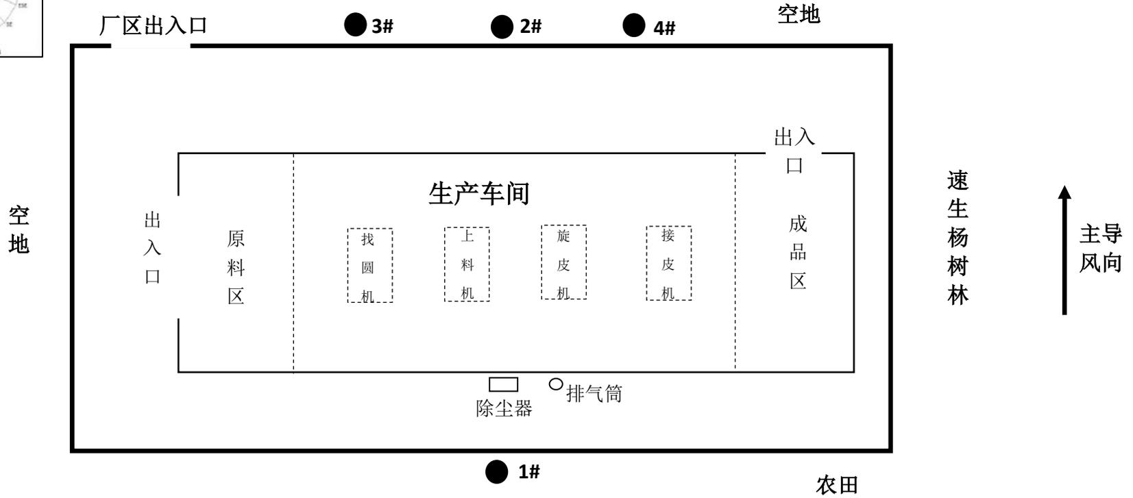
图 9.2-1 项目无组织废气监测点位示意图 (2019. 3. 24)
