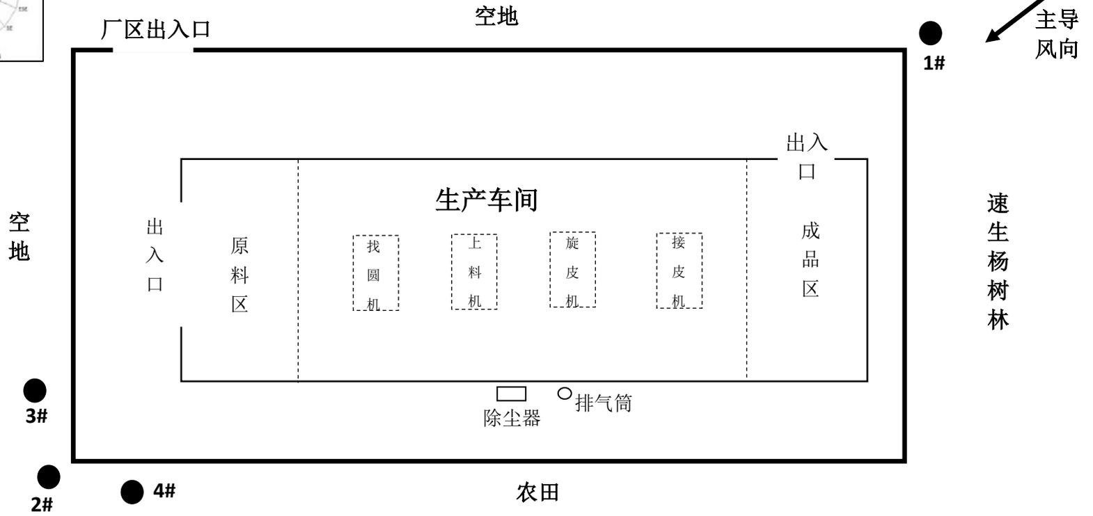
图 9.2-1 项目无组织废气监测点位示意图 (2019. 3. 23)
