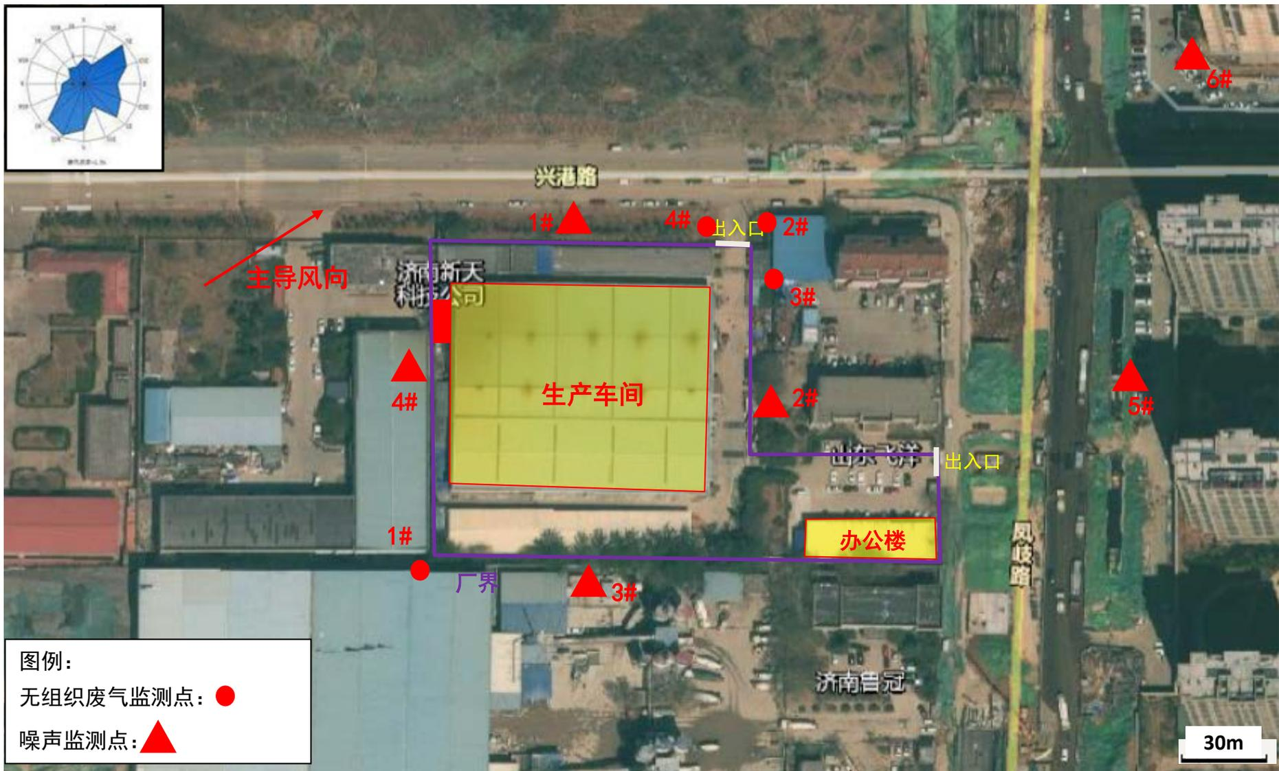
图 9.2-1 本项目无组织废气、噪声监测布点示意图
