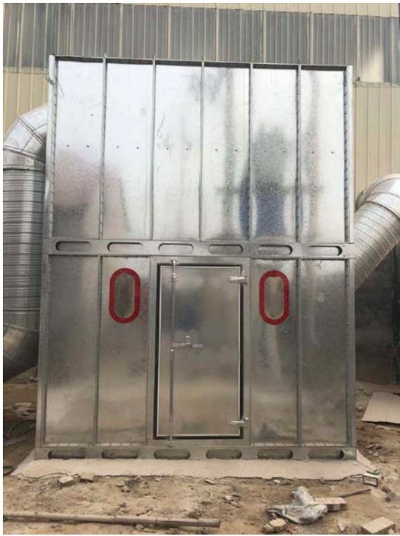
脉冲除尘器（建筑垃圾资源利用生产线）
