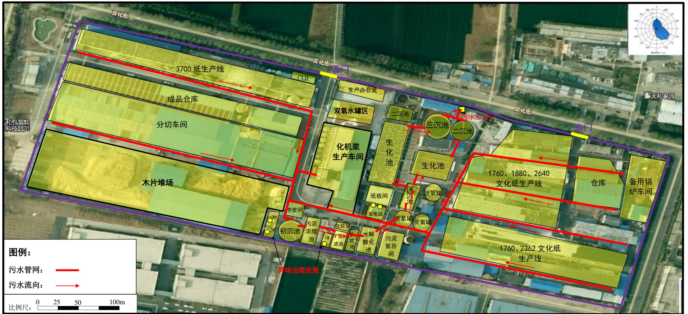
图 7.2-8 项目厂区污水管网走向图
