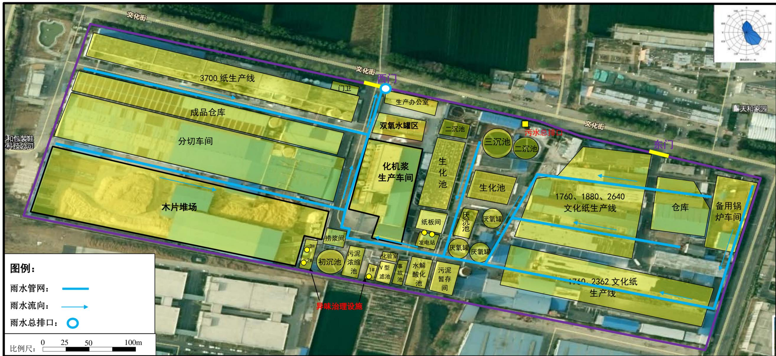
图 7.2-9 项目厂区雨水管网走向图
