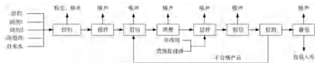
图 3.5-5 水悬浮剂产品生产工艺流程及产污环节图
