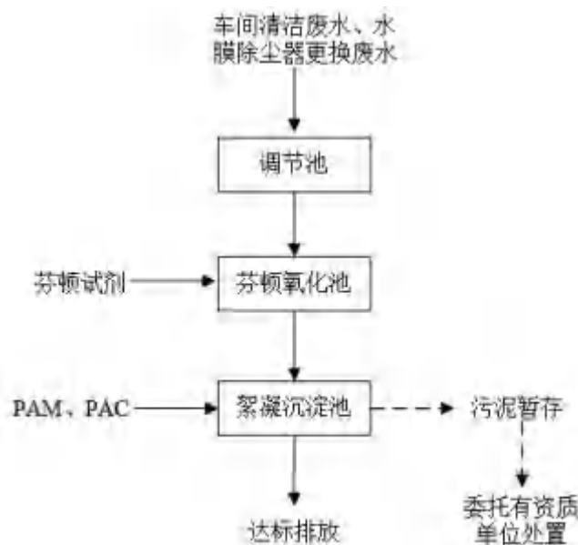
图 4.1-1 厂区污水处理站处理工艺图
